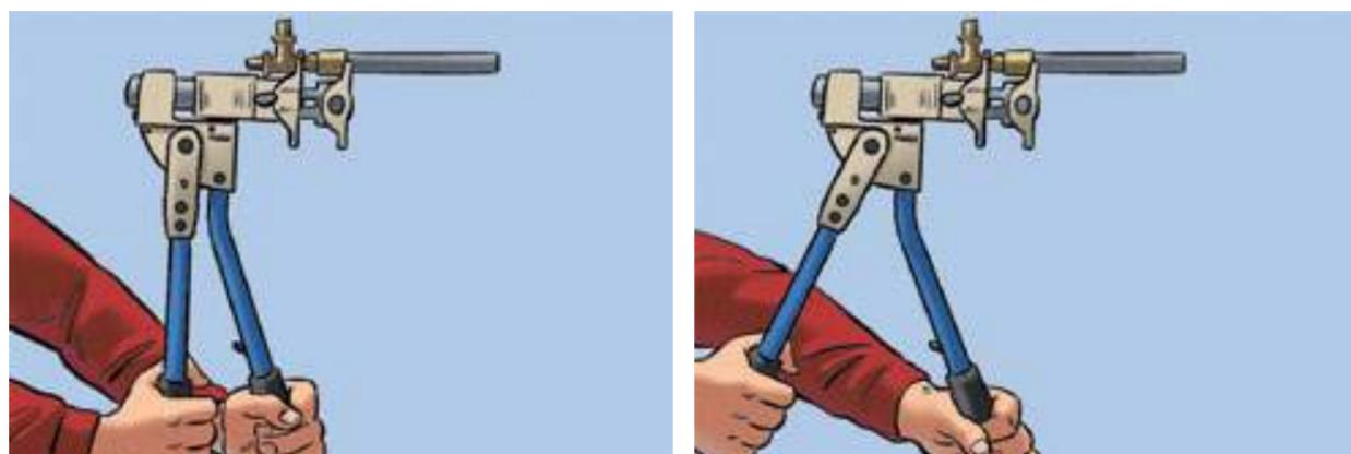
5. Надвинуть гильзу на фитинг до упора с помощью ручного или гидравлического пресса. В процессе напрессовки инструмент держать под прямым углом, исключая перекосы фитинга и гильзы в губках тисков и относительно друг друга.
